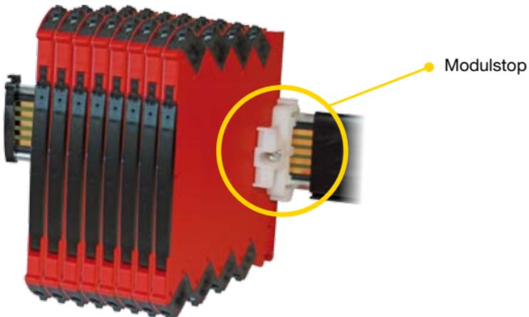
Alle moduler kan monteres på power rail (PR varenummer 9400) og om nødvendigt holdes fast med modulstop til power rail (PR varenummer 9403). Der kan monteres spændingsforsyninger på power railen i henhold til kundens behov.
